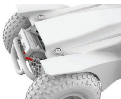
Figure 4.6a Leviers de frein enclenchés de l'Extreme X8
