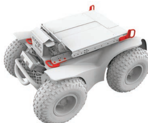
Figure 5.4d Points d'arrimage du l'Extreme X8
