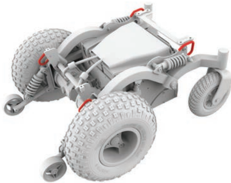
Figure 5.2c Points de levage du Frontier V4
