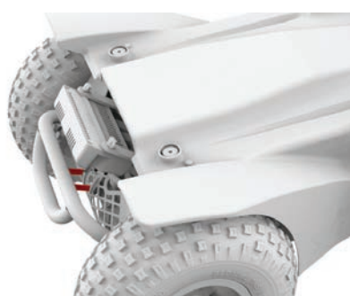
Figure 4.6b Leviers de frein libérés de l'Extreme X8
