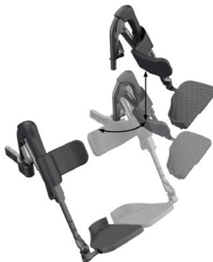
Figure 4.2c Repose-jambes montrant l'action d'escamoter pour le retrait
