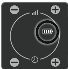
**b** Lorsque le Revitive est éteint, mais en cours de chargement, l'icône d'indicateur de charge ne cesse de défiler ; elle s'arrête de défiler dès que la batterie est entièrement chargée.
