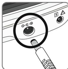
**c** Branchez l'adaptateur d'alimentation dans la prise murale la plus proche. Cela enclenche le chargement de la batterie rechargeable (intégrée).
