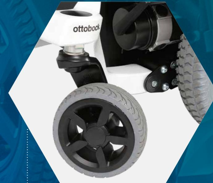
Le « Torsion Drive System (TDS) » permet au Juvo 6 roues d'être en contact permanent avec le sol, évitant ainsi les effets « cuvettes » lors du passage d'obstacles et optimisant le confort de conduite. Ce système est breveté.
