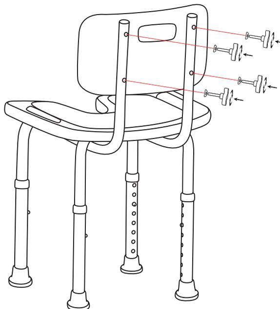
**IMPORTANT :** Vérifiez régulièrement le bon serrage des vis pour garantir une utilisation en toute sécurité. En cas de vis défectueuses, de jeu dans l'assise après montage ou de mauvais fonctionnement des cliquets de réglage de la hauteur, contactez votre revendeur (voir illustration ❶).
