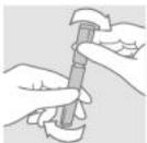
2 Dévisser en tournant les deux parties en direction opposée. Tirer la poignée jusqu'à sentir une résistance. Continuer à tirer délicatement jusqu'à ouverture complète de la sonde.
