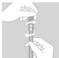
1 Tenir la sonde verticalement en maintenant la partie avec le bouchon vers le haut. Dévisser en tournant les deux parties en direction opposée.
