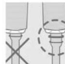
3 Pour s'assurer que la sonde est bien ouverte, vérifier que le corps de la sonde est totalement sorti.
