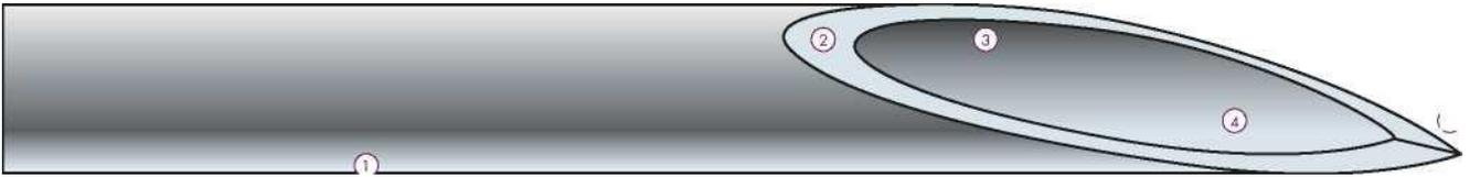
1. Soudage au laser : **chaque aiguille est au départ un ruban d'acier inoxydable répondant aux critères de la norme internationale relative à l'acier chirurgical. Ce ruban est enroulé sous une forme tubulaire et ensuite soudé au moyen d'un laser performant. La surface de l'aiguille présente une qualité supérieure, améliorant ainsi le confort à l'injection**
