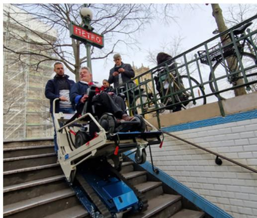
Ce monte-escalier dispose de 4 sangles et d'un appui-tête pour augmenter la sécurité du passager et limiter les mouvements parasites lors des déplacements.
